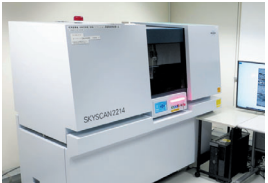
超微細四次元X線CT解析装置
